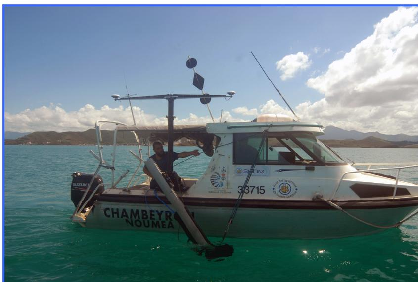
*Sondeur multifaisceaux sur perche amovible*
