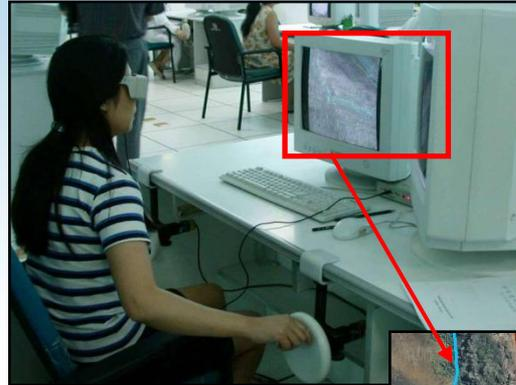
L'opératrice utilise la stéréoscopie et obtient une zone en 3D. Il peut ainsi restituer les objets du terrain et sa topographie avec leurs altitudes.
