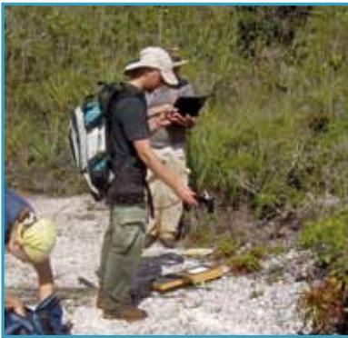
Acquisition de données terrain par spectro-radiométrie in situ.
