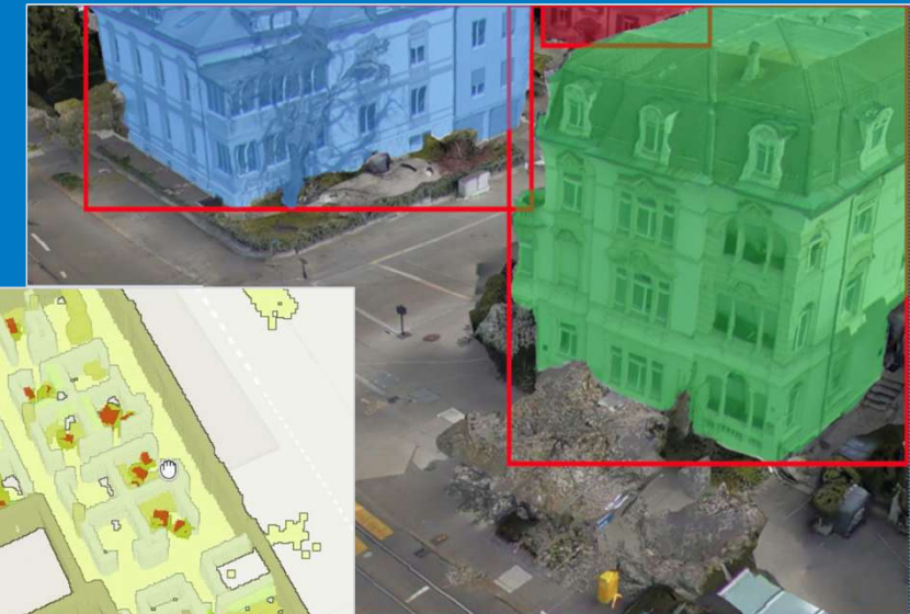
Extraction automatique de bâtiments dans un photomaillage 3D
